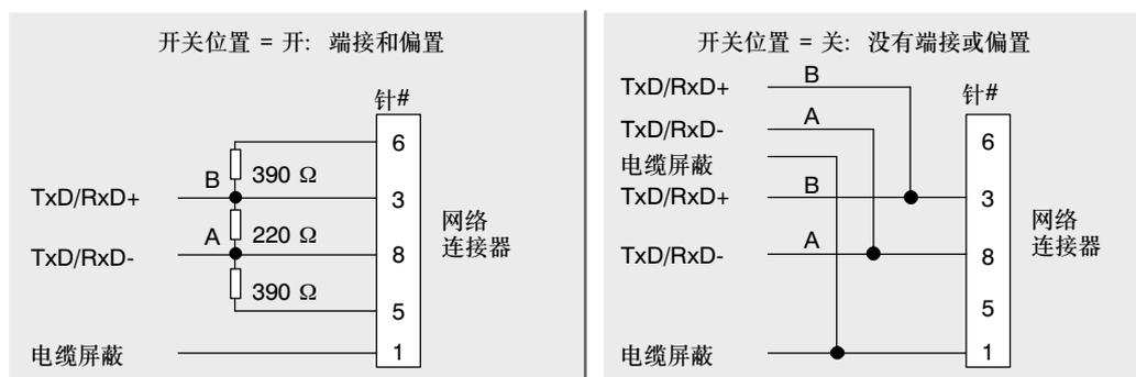
图11-5 网络电缆的偏置和终端
