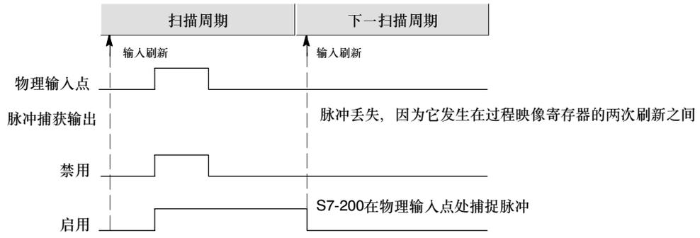
图4-26 带有和不带有脉冲捕获功能的S7-200操作
