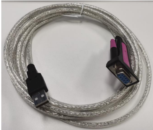
〈图 2-2 USB 转 RS-232 调试电缆〉
