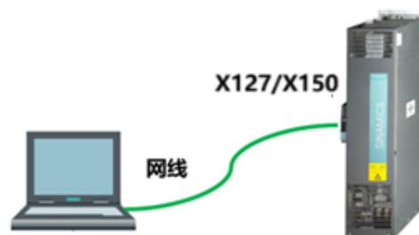
PG/PC 连接 G130G150 的服务接口 X127 或 CU320-2PN 接口 X150
