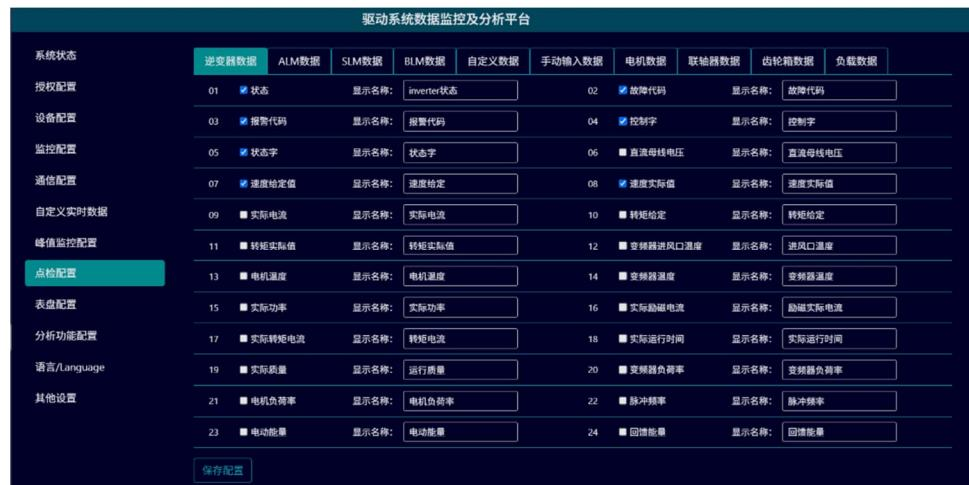
配置完成后选择主菜单中的“现场点检”按钮即可看到刚才配置点检的设备的所有变量值，通过“选择点检轴”按钮可以对轴进行过滤，通过“保存点检表”按钮可以保存当前点检表，方便后面查询。
